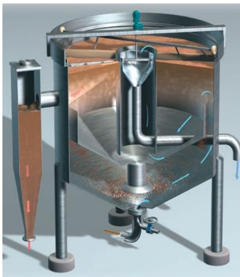
Figur 8: Eksempel på flotasjonsanlegg, MUSLING® (Veolia Krüger Kaldnes)
